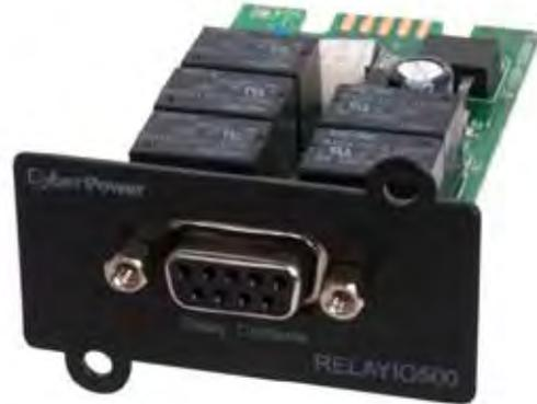
Die CyberPower RELAYIO500 Onsite Management Card ist ein optionales Management-Add-On für bestimmte CyberPower USV-Serien. Nach dem Einsetzen der Karte in den Erweiterungsanschluss der USV können über die Karte Statusmeldungen, einschließlich USV-Störungen, Überlastungen, Übertemperaturen usw. abgefragt werden. Zusätzlich bietet die Karte einen Eingangskontakt für die Fernabschaltung der USV im Batteriebetrieb.
