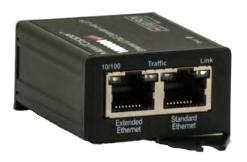
Die Geräte der Serie VI-UTP-2300A übertragen 10/100Mbps Ethernet und PoE/PoE+ mit UTP, bzw. Cat-Kabel bis zu einer Distanz von 500m. Die Pass Through Technologie ermöglicht es, die PoE Speisung z.B. eines Midspans direkt über UTP, bzw. Cat-Kabel weiterzugeben. Die Geräte brauchen keine Software-Konfiguration. Diagnose LEDs dienen der Übersicht des Betriebzustandes. Die Module der Serie VI-UTP-2300A sind als Tischmodelle, auf Hutschiene und in 19"-Schränken montierbar.
