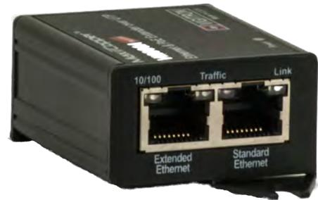
Die Geräte der Serie VI-UTP-2300A übertragen 10/100Mbps Ethernet und PoE/PoE+ mit UTP, bzw. Cat-Kabel bis zu einer Distanz von 500m. Die Pass Through Technologie ermöglicht es, die PoE Speisung z.B. eines Midspans direkt über UTP, bzw. Cat-Kabel weiterzugeben. Die Geräte brauchen keine Software-Konfiguration. Diagnose LEDs dienen der Übersicht des Betriebszustandes. Die Module der Serie VI-UTP-2300A sind als Tischmodelle, auf Hutschiene und in 19"-Schränken montierbar.
