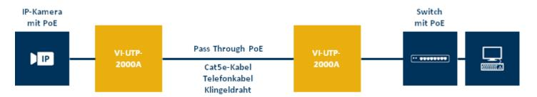
Die Geräte der Serie VI-UTP-2300A übertragen 10/100Mbps Ethernet und PoE/PoE+ mit UTP, bzw. Cat-Kabel bis zu einer Distanz von 900m. Die Pass Through Technologie ermöglicht es, die PoE Speisung z.B. eines Midspans direkt über UTP, bzw. Cat-Kabel weiterzugeben. Die Geräte brauchen keine Software-Konfiguration. Diagnose LEDs dienen der Übersicht des Betriebzustandes. Die Module der Serie VI-UTP-2300A sind als Tischmodelle, auf Hutschiene und in 19"-Schränken montierbar.
