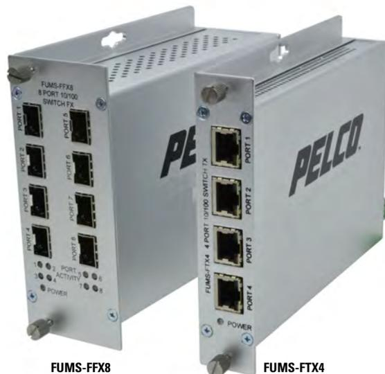
Durch die Modulbauweise können diese Modelle entweder an der Wand oder im Rack montiert werden. LEDs zeigen den Betriebsstatus an und dienen zur Überwachung von kritischen Betriebsparametern. Diese Modelle wurden für den Betrieb bei extremen Temperaturen entwickelt. Für die Geräte der **FUMS-F-Serie** ist eine externe Stromversorgung erforderlich. Es empfiehlt sich die Verwendung eines externen FEXTPS-Netzteils für Faseroptikgeräte.
