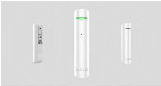
„GlassProtect“ ist ein drahtloser Sensor, der Glasbruch bis zu einer Entfernung von 9 Metern registriert. Er wird an das „Ajax“ Sicherheitssystem über das geschützte Protokoll „Jeweller“ angeschlossen, die Reichweite beträgt, ohne Hindernisse, bis zu 1000 m. Die mitgelieferte Batterie hat eine Lebensdauer von bis zu 7 Jahren und ist für die Nutzung im Innenbereich vorgesehen.
