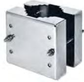
Stangenadapter zur Verwendung mit EXP2230-Kameras oder explosionsgeschützten Waschern. Für Stangendurchmesser von 110 mm (4.3") bis 150 mm (5.9"). Max. Last: 50 kg (110 lb.). Edelstahl AISI 316L.
