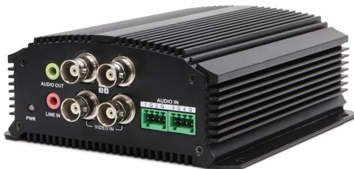
Der **DVE-4** ist ein analoger Audio- und Video-Encoder. Er kann Audio- und Videodaten über seinen BNC-Eingang empfangen, encodieren und simultan über Ethernet (unicast oder multicast) an einen Empfänger streamen.
