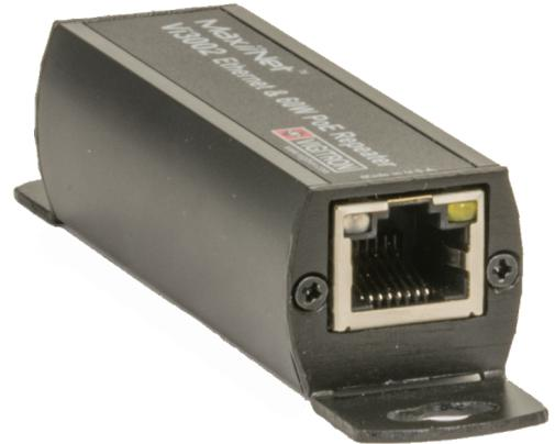
Der VI-3002 ist ein 10/100Mbps Ethernet und PoE/PoE+/PoE++ Repeater. Der Repeater ermöglicht es zwei oder mehr UTP-Cat5/6 Kabelstrecken zusammen zu schliessen und so die Kabeldistanz zu vervielfachen. Die Geräte brauchen keine Software-Konfiguration. Diagnose LEDs dienen der Übersicht des Betriebszustandes. Durch die kleinen Abmessungen können die Repeater auch in sehr engen Platzverhältnissen montiert werden.
