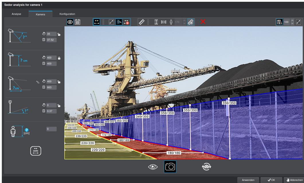
Die SEDOR® AI Intruder Detection Software erlaubt die Absicherung frei definierbarer Flächen im Innen- und Außenbereich vor unbefugtem Zutritt. Die Analyse-Software erkennt Objekte, die sich einem definierten Bereich annähern und bewertet deren Bewegungsrichtung und Verweildauer. Die detektierten Ereignisse werden einer leistungsfähigen Objektklassifizierung auf Basis neuronaler Netze zugeführt und schließlich mit einer entsprechenden Meldung alarmiert.
