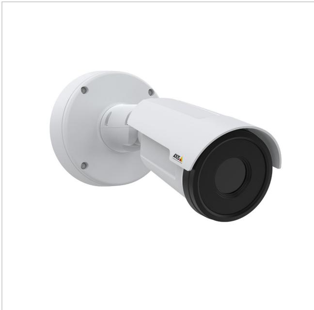
Wärmebild Netzwerk Kamera, 13mm, 28°, 384x288, 30fps, Audio, Außen, IP66/67, IK10
