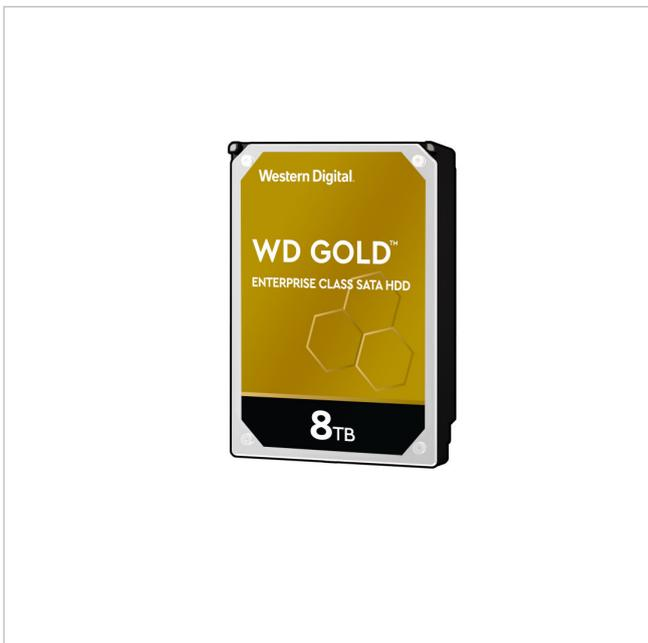
Festplatte, 3,5", SATA 6Gb/s, 8TB, 7200RPM, 256MB Cache, 24/7 Betrieb, R/V Sensor
