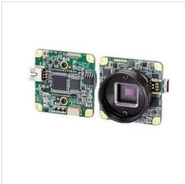
Mini-USB Farb-Platinenkamera 640x480, 1/3" CS-Mount, abgewinkelter USB-Anschluss
